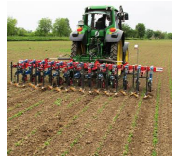
HABIHT Bineuse attelage arrière avec guidage caméra pour cultures de soja 12 rangs + bineuses à doigts
