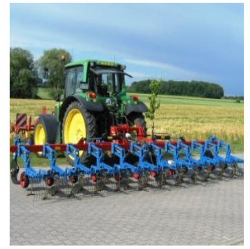
HABIHT bineuse 12 rangs pour culture de betteraves, attelage arrière avec guidage par caméra
