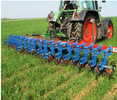
HABIHT bineuse attelage arrière avec guidage caméra pour cultures de blé
