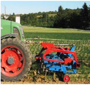
HABIHT bineuse frontale avec bineuses à doigts pour cultures de ciboulette
