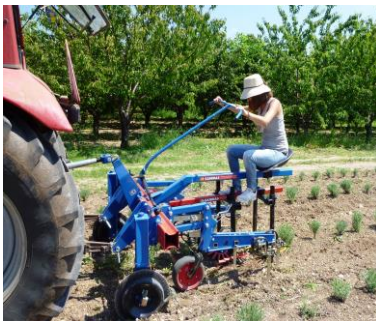
HABIHT bineuse attelage arrière avec guidage de précision pour culture de lavande
