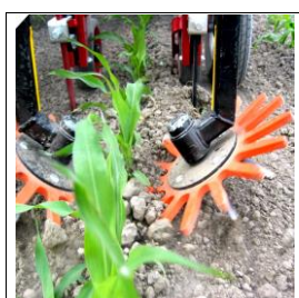
Grandes bineuses à doigts K.U.L.T.- Kress, souples en maïs
