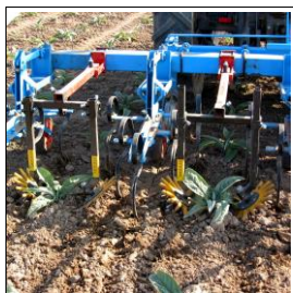
Le support Kress peut être monté sans difficulté sur toutes bineuses
