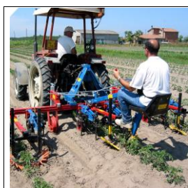
L'ensemble bineuse avec guidage ma- nuel permet un tra- vail d'une grande précision
