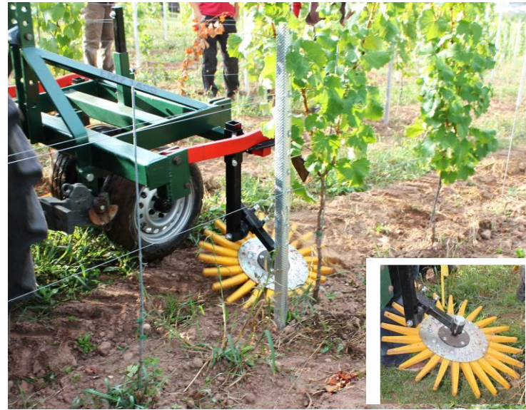
Bineuse à Doigts MAXI Ø 700 mm, Jaune (medium) Largeur entre rangs à partir de 150 cm
