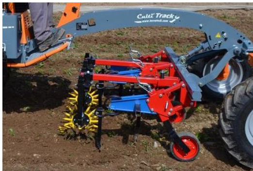
ARGUS Bineuse pour légumes, 2/3 rangs avec dents vibro pour modèle Culti Track de Terrateck
