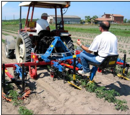
ARGUS bineuse montage sur partie arrière avec guidage de précision pour culture des tomates
