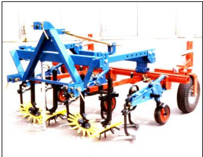
ARGUS Bineuse pour fraises, 2 doubles rangs avec dents vibro, montage frontal
