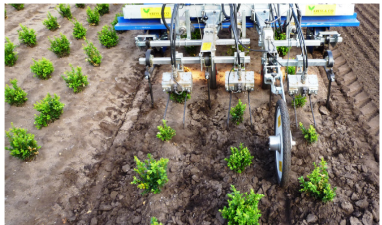
Auch in niedrigen Baumschul-Reihenkulturen leistet der Robovator hervorragende Arbeit, wie hier in Buchsbaum
