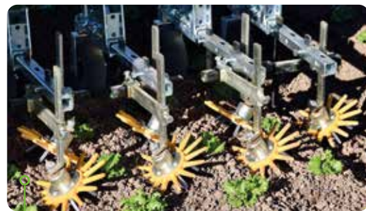
Die kleine Fingerhacke mit 24 cm, gelb, eingesetzt im Roboter von Naio zur Pflege in Salat.
