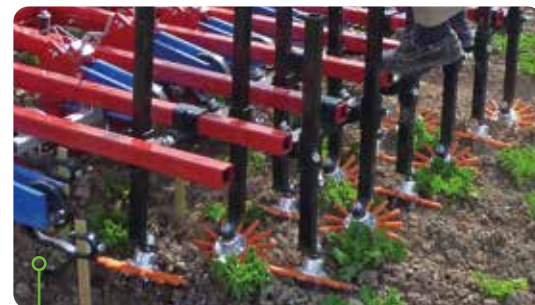
8-reihiges Hacksystem für Salat mit manueller Steuerung und Fingerhacke 31 cm, orange.
