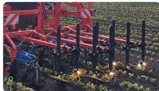
4-reihiges Parallel Verschiebesystem mit Fingerhacke 31 cm, gelb in Rote Beete.
